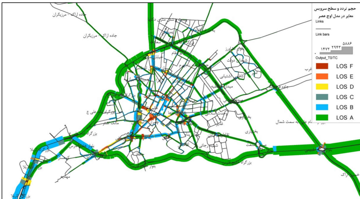
شکل ۱-۱۶- حجم تردد و سطح سرویس معابر در ساعت اوج عصر در سال ۱۴۰۵ در گزینه شماره ۶
