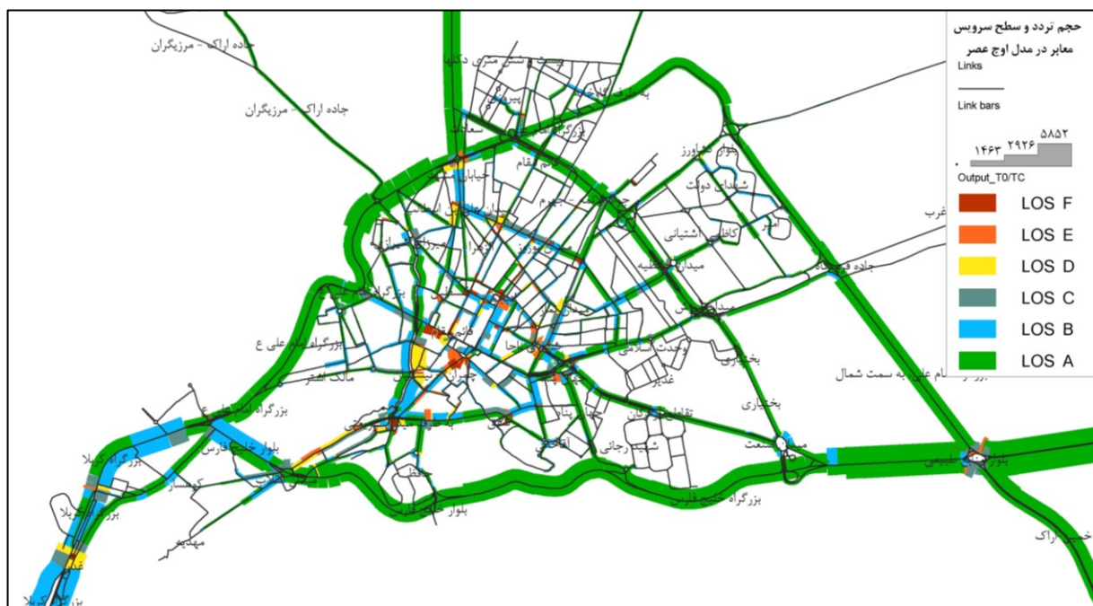
شکل ۱-۲۳- حجم تردد و سطح سرویس معابر در ساعت اوج عصر در سال ۱۴۰۵ در گزینه شماره ۹
