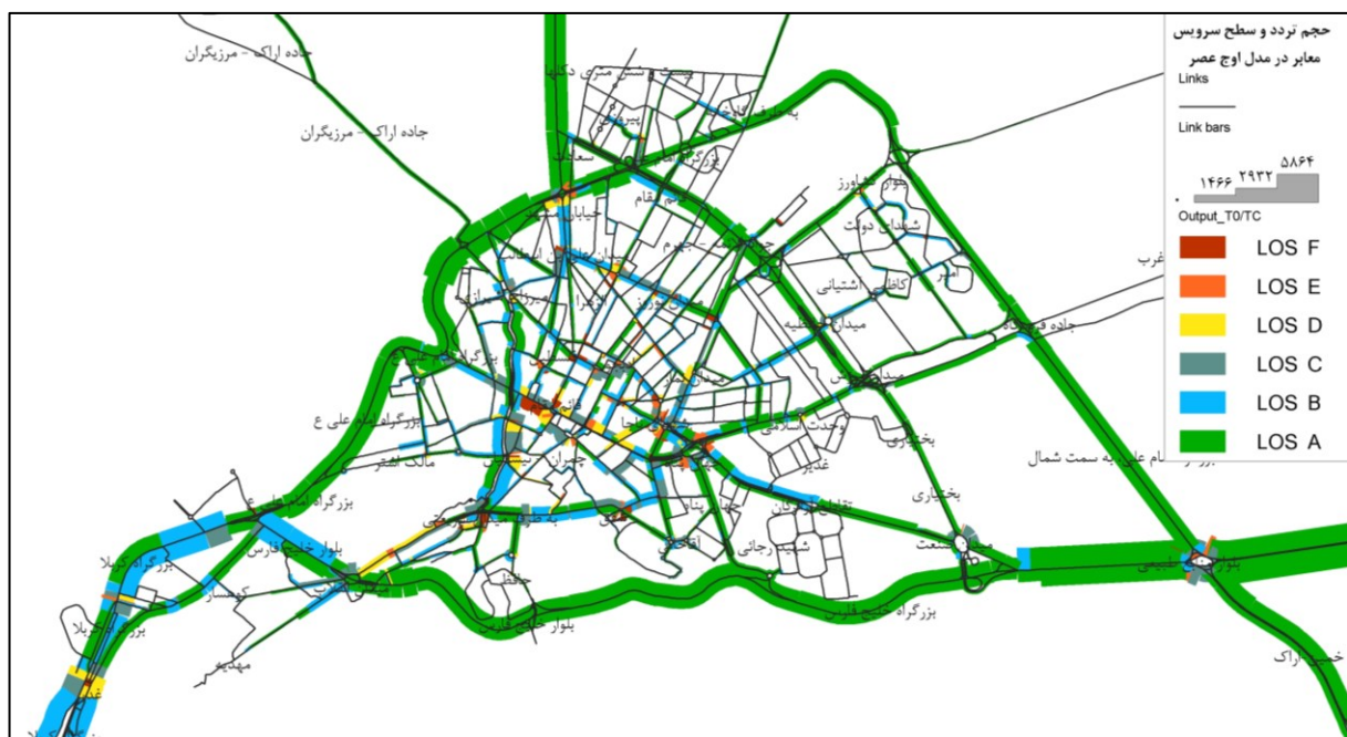
شکل ۵-۱- حجم تردد و سطح سرویس معابر در ساعت اوج عصر در سال ۱۴۰۵ در گزینه شماره ۱
