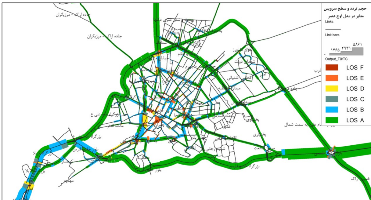
شکل ۹-۱- حجم تردد و سطح سرویس معابر در ساعت اوج عصر در سال ۱۴۰۵ در گزینه شماره ۳
