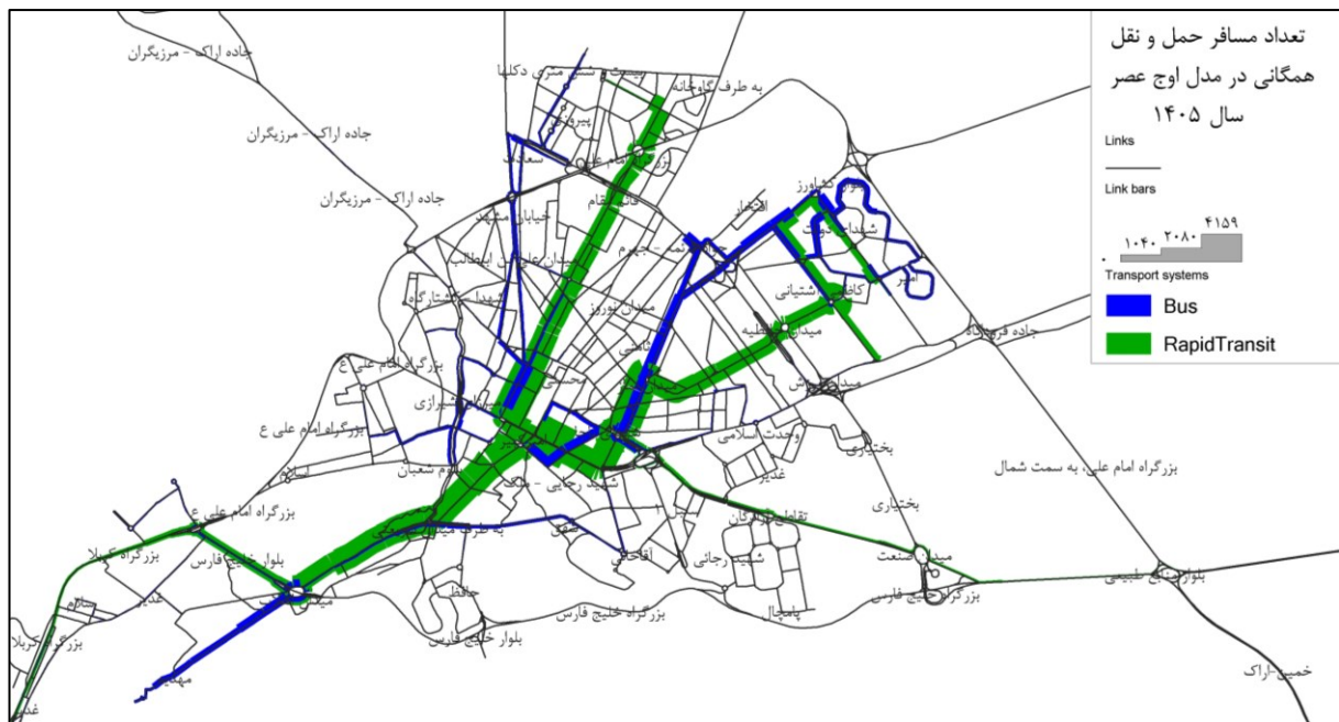
شکل ۸-۱- تعداد مسافر حمل و نقل همگانی به تفکیک نوع وسیله نقلیه در ساعت اوج عصر در سال ۱۴۰۵ در گزینه ۲
